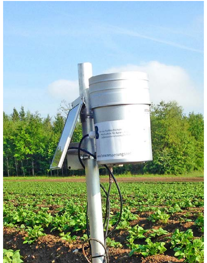
Une sonde mesure l'humidité du sol et permet ainsi une irrigation ciblée. © BFH-HAFL.
