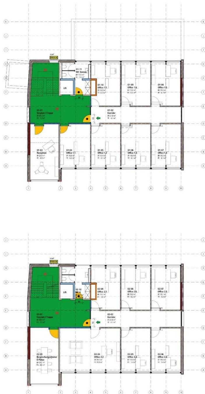
Fig. 42 : Plans sécurité incendie 1 er et 2 e étages
