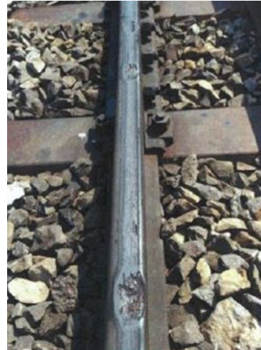
Illustration 2 : Enfoncement d'un rail
