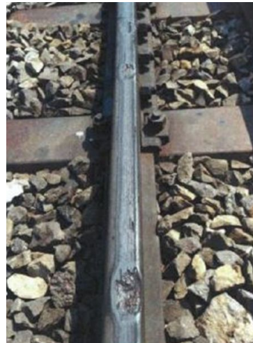
Abbildung 2: Flachstellen auf Schiene
