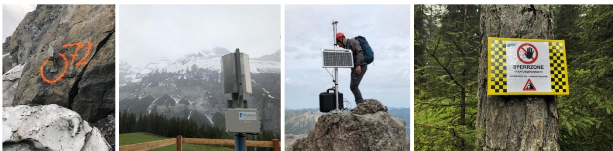
Abbildung 9 Von links nach rechts: Messspiegel, automatischer Tachymeter zur Messung der Spiegel vom Gegenhang, GPS-Station, Signalisation Absperzung (Fotos: Abteilung Naturgefahren).
