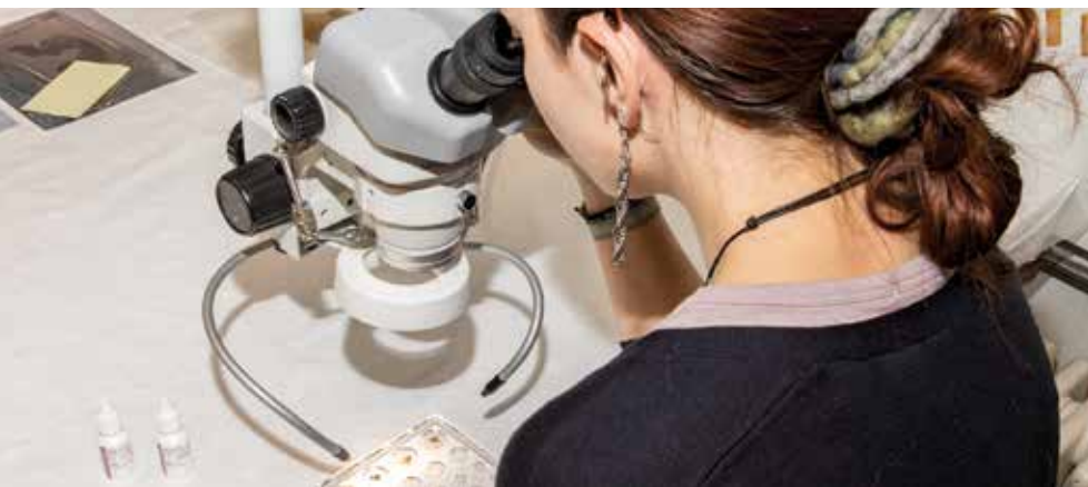
➤ Illustration du projet MICMAC: Microtest pour vérifier la présence de contamination ferreuse dans du bois archéologique gorgé d'eau.
